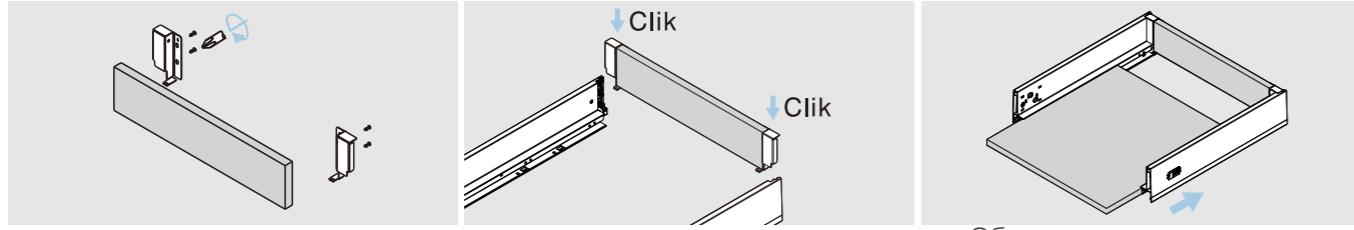
Сборка задней стенки ящика
