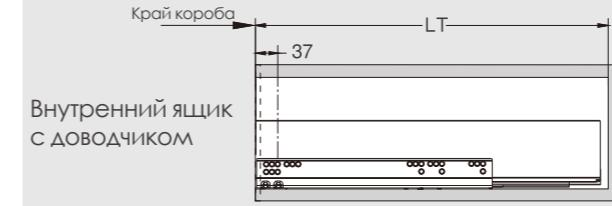
Для присадки внутреннего ящика с использованием передней металлической панели на направляющих Push-open
