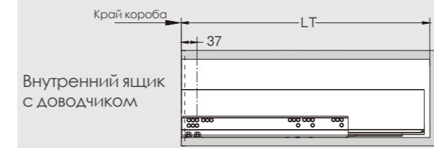
Для присадки внутреннего ящика с использованием передней металлической панели на направляющих Push-open
