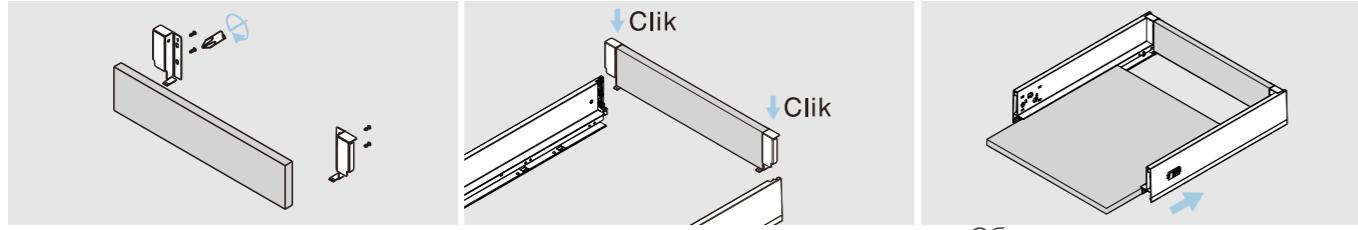
Сборка задней стенки ящика
