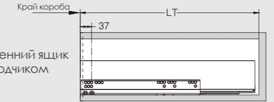
Для присадки внутреннего ящика с использованием передней металлической панели на направляющих Push-open
