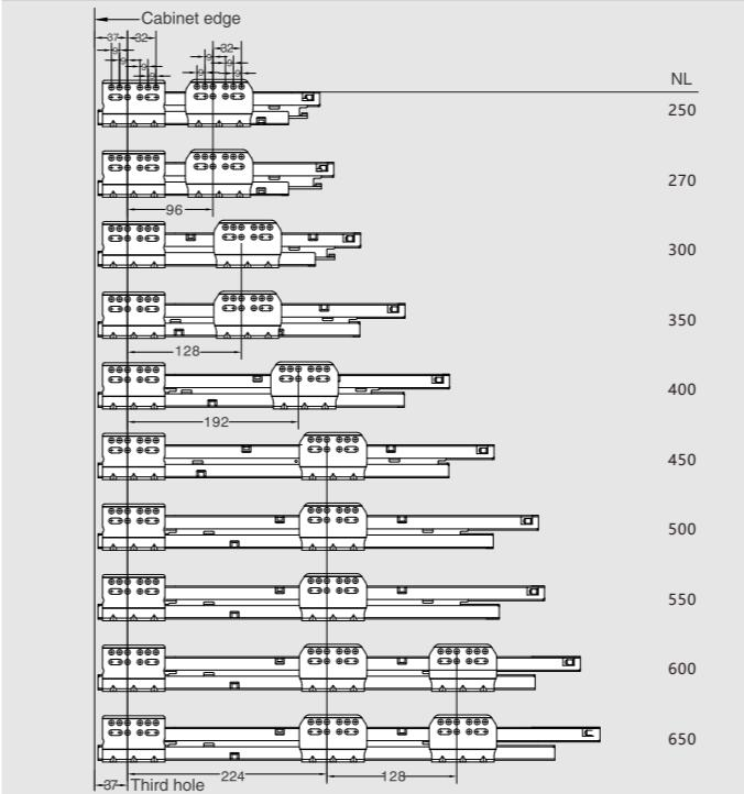
Установочные размеры: передняя, задняя панель и дно ящика (мм)
